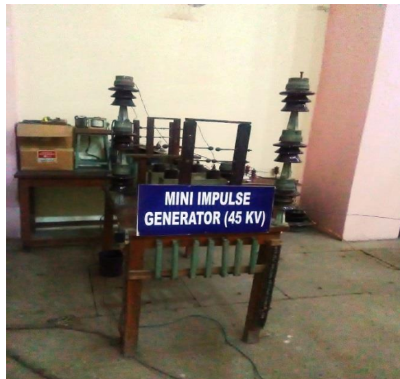
Figure 3: Mini Impulse Generator (45KV)
